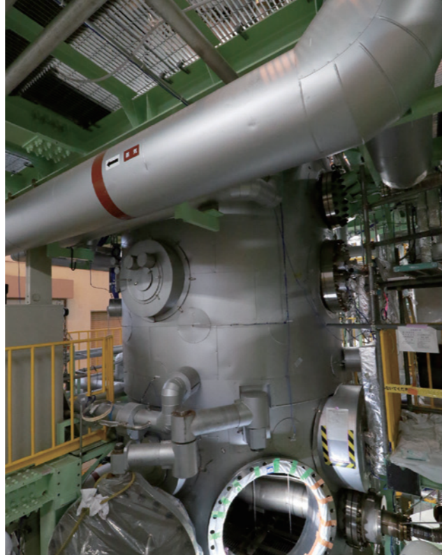
大型格納容器実験装置CIGMA(シグマ)
